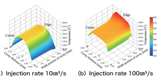
キャビティ流動樹脂内部の3次元温度分布計測（材料：PP）
