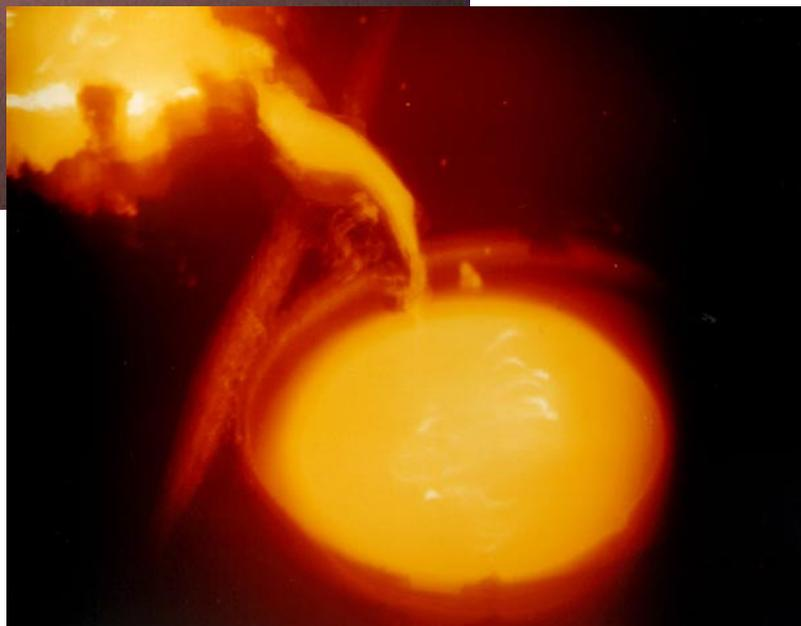
EBトラフ溶解・鋳造工程
