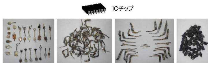
中心部の金属素材 金属足部分 部品内部の金属 プラスチック 電気パルス粉碎によってICチップの単体分離された各種素材
